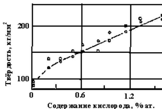
Рис.10. Изменение микротвердости циркония с увеличением содержания кислорода [12]
