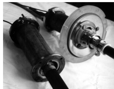
Рис.3. Внешний вид пневмоизлучателей ПИК-1 и ПИК-2
