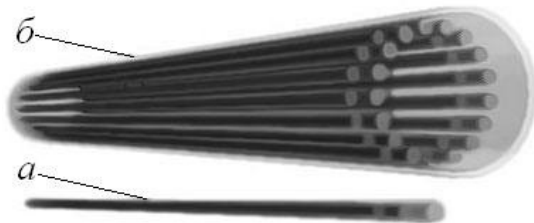
Рис. 1. Трехмерные компьютерные модели двух вариантов конструкции гамма-источников на базе изотопов европия: тонкий источник (а) и толстый составной источник (б)
