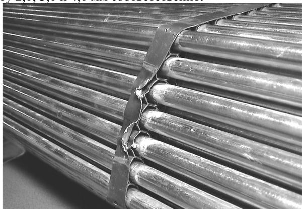
Рис. 8. Характер повреждения ДР при выемки ТВС
