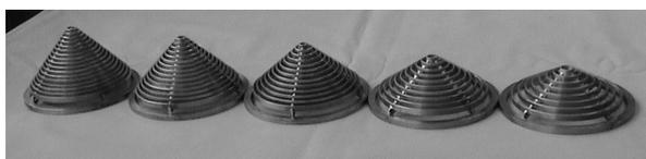
Рис. 7. Внешний вид антидебрисных фильтров
