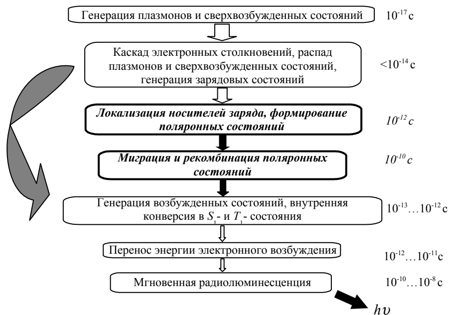
Рис. 4. Схематическая диаграмма процесса формирования сцинтилляционного импульса в областях низкой плотности активации органических молекулярных систем
