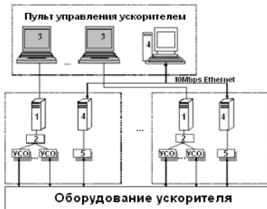
Рис.2. Структурная схема СУ ЛУ в 1996-2000 гг. (1 – ЭВМ СМ1420; 2 – УВВ; 3 – Монитор; 4 – компьютер с 486 процессором; 5 – крейт КАМАК)
