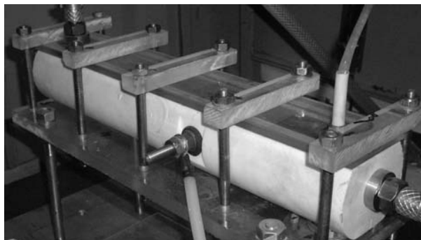
Рис.1. Реактор с продольным потоком жидкости для получения золей мелкодисперсных металлов
