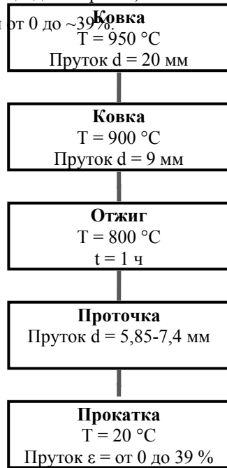
Рис. 1. Схема изготовления прутков при холодной деформации
