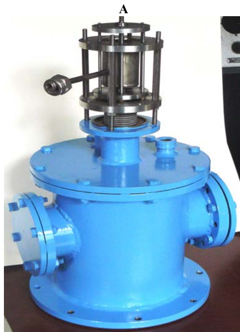
Рис. 7. Схема (А) и фотография (Б) экспериментального устройства для изучения механических свойств материалов под пучком ионов
