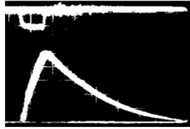
Рис.1. Импульс неравновесной проводимости в полупроводнике (нижняя осциллограмма) при воздействии на полупроводник импульсного пучка ускоренных электронов (верхняя осциллограмма)
