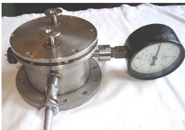
Рис. 5. Камера для облучения образцов в сборе
