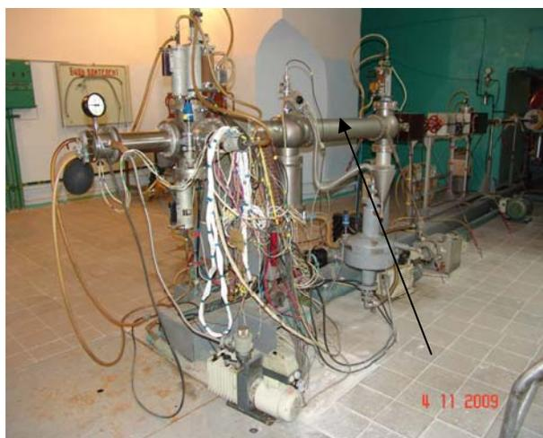
*Рис. 2. Электропровод с вакуумной системой откачки, системами настройки и управления пучком*
