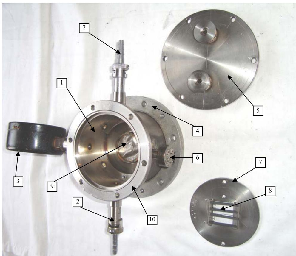
Рис. 4. Конструктивные элементы камеры облучения: 1 - корпус камеры; 2 - клапаны для вакуумирования объема камеры и подачи требуемой газообразной среды; 3 - моновакууметр; 4 - фланец для подсоединения камеры к электропроводу; 5 - водоохлаждаемая крышка камеры; 6 - гермоввод для подключения термопар; 7 - фланец для крепления облучаемых образцов; 8 - облучаемые образцы; 9 - диафрагма; 10 - фланец для крепления водоохлаждаемой крышки камеры
