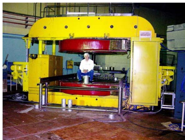
Рис.1. Электромагнит с системой подъема верхней балки
