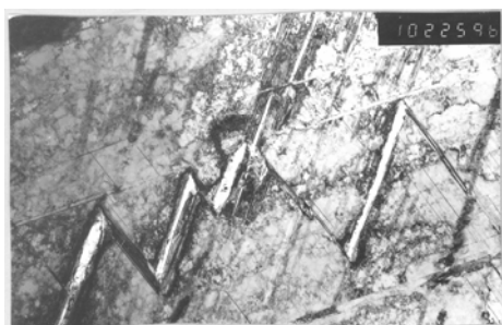
Рис. 7. Два морфологических типа мартенситной \alpha' -фазы в зоне шейки деформированного необлученного образца из нержавеющей стали 12X18H10T ( \times 50000 )
