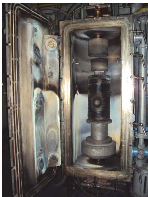
Рис. 1. Внешний вид и эскиз технологической оснастки для высокотемпературной вакуумно-термической обработки материалов. На эскизе: 1 – крышка тигля; 2 – нагреватель; 3 – тигель; 4 – теплоизолирующий экран; 5 – окно терпары; 6 – подставка; 7 – теплоизоляция; 8 – графитовая плита
