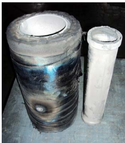
Рис. 2. Внешний вид нагревателя и теплового экрана для высокотемпературной вакуумно-термической обработки
