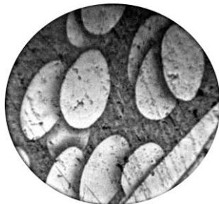
Рис. 7. Обработанные участки при равномерном распределении интенсивности излучения в лазерном пучке
