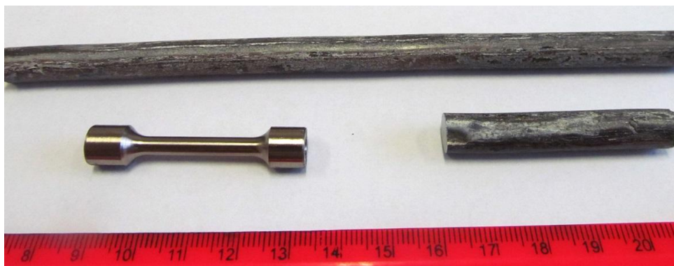
Рис. 2. Прутки сплава Zr-1%Nb, полученные прокаткой, и выточенный из прутка образец для механических испытаний
