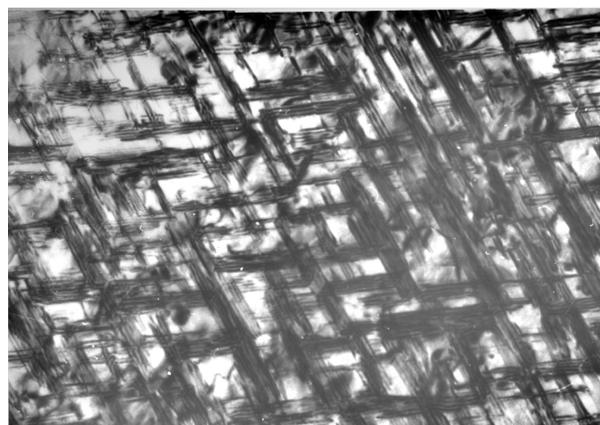
Рис. 2. Структура стали X13N13, облученной до дозы 100 сн.а.
