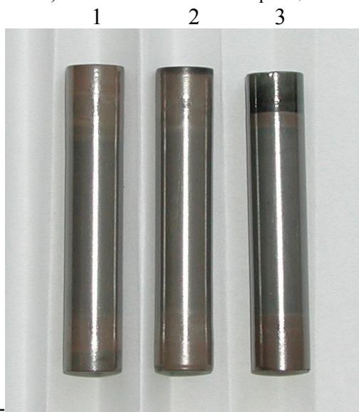
Рис. 4. Вид сваренных образцов оболочек и заглушек (по типу моделей твэлов) после испытаний в автоклаве при 400°C, давлении 20,0 МПа, изготовленных из сплава Zr1Nb (два образца, 1,2) и Э110 (3). Длительность испытаний 10000 ч
