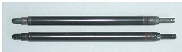
Рис.1. Вид моделей твэлов после испытаний в автоклаве при 350°C, давлении 16,5 МПа, изготовленных из кальциетермического сплава Zr1Nb (верхний образец) и штатного сплава Э110 (нижний образец). Длительность испытаний 12000 ч
