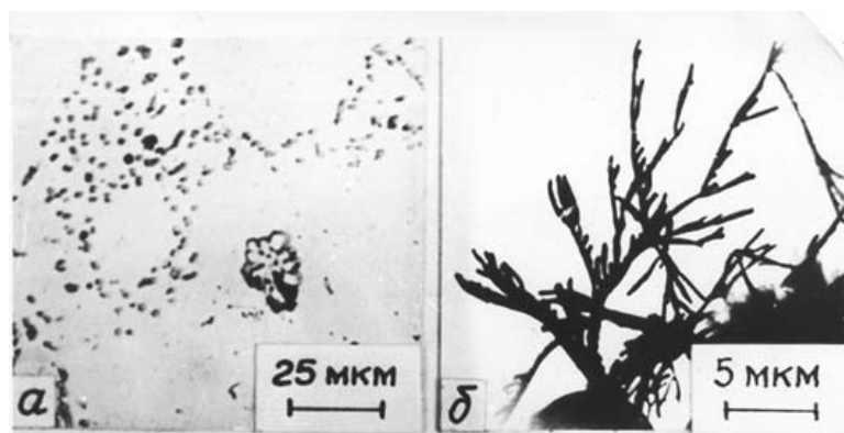
Рис.11 Микроструктура сплава меди с 1,5% ниобия: а - металлографический шлиф; б - электронномикроскопический снимок
