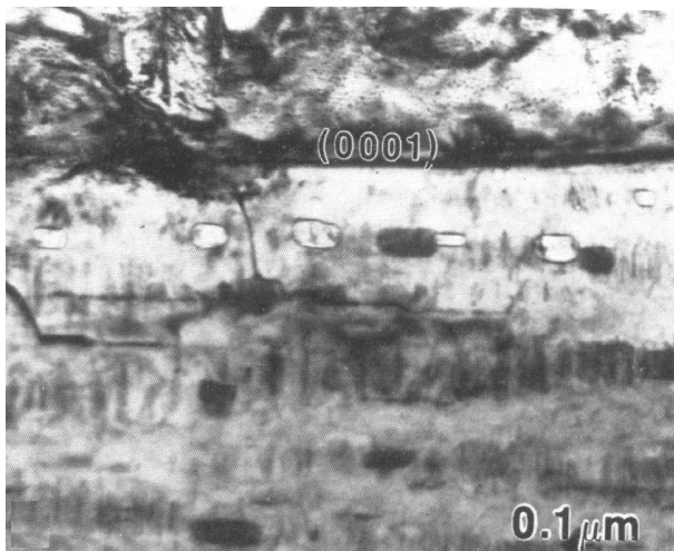
Рис. 2. Выстраивание пор в ряды, параллельные плоскости (0001): а – сплав циркалой-2, облученный в EBR-II при температуре 665 К до флюенса 1,6 \cdot 10^{26} нейтр./м 2 ( E > 1 МэВ); б – сплав циркалой-2, облученный нейтронами при температуре 700 К до флюенса 4,2 \cdot 10^{25} нейтр./м 2 ( E > 1 МэВ) [28]
