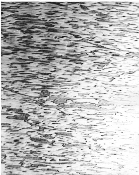
Рис. 3. Микроструктура сплава Cu-15%Sn-0,4%Ti после горячего выдавливания,  $\times 100$ , продольный шлиф
