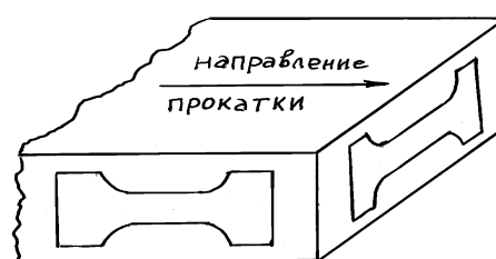
Рис. 1. Схема вырезки образцов для механических испытаний из прокатанных пластин
