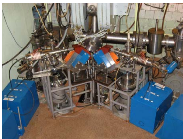
Рис. 5. Общий вид комплекса из трех ускорителей заряженных частиц
