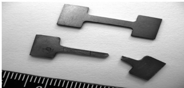
Рис. 2. Образцы гафния до и после испытаний
