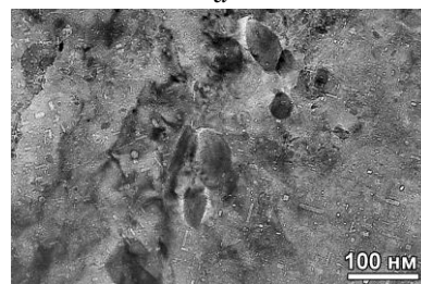
Рис. 4. Микроструктура стали ЭП-450 в феррите (а) и сорбите (б) после одновременного облучения \text{Cr}^{3+} , D = 200 \text{ сна} , \text{He} - 100 \text{ аррм} , T = 480 \text{ }^\circ\text{C}
