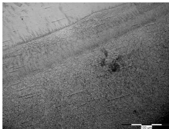
Рис. 9. Структурная неоднородность ( \times 400 ) в зоне сплавления при шестислойной наплавке АрДС
