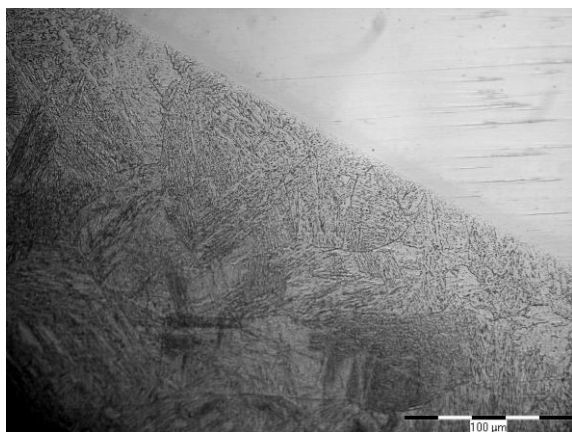
Рис. 4. Структура ЗТВ ( \times 400 ) в окрестности зоны сплавления при наплавке неподвижной дугой способом АрДС
