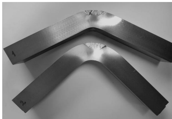
Рис. 13. Образец контрольного ремонтного сварного соединения стали 15X2МФА
