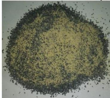
60 vol.%  $B_4C$  + 40%vol.  $HfO_2 \cdot Dy_2O_3$
