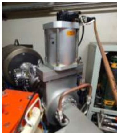
Fig. 17. Fast gate valve DN 63–160
